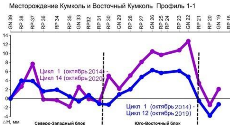
Рисунок 4.5 – Графики вертикальных движений земной поверхности вдоль профиля 1-1 за период между циклом 1 (октябрь 2014) и циклом 12 (октябрь 2019), а также между циклом 1 (октябрь 2014) и циклом 14 (октябрь 2020)
