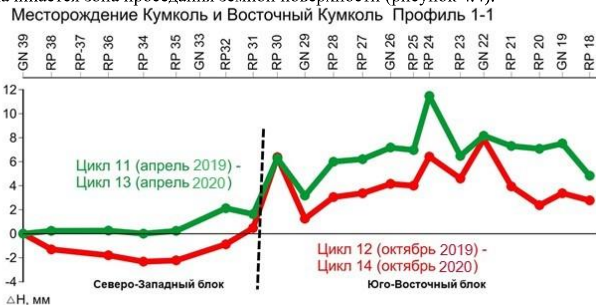
Рисунок 4.4 – Графики вертикальных движений земной поверхности вдоль профиля 1-1- за интервалы времени между циклом 11 (апрель 2019) и циклом 13 (апрель 2020), а также между циклом 12 (2019) и циклом 14 (октябрь 2020)
