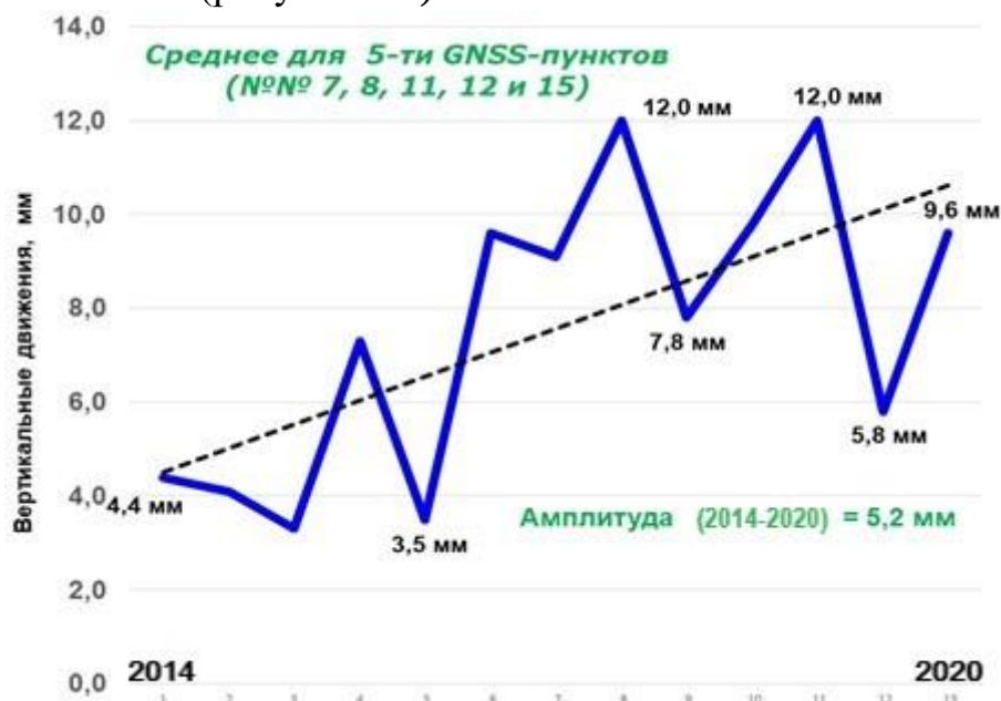
Рисунок 5.5 – График изменения средних значений высотных отметок информативных пунктов, входящих в состав блока 1 за интервал времени между циклом 1 (2014) и циклом 14 (2020)
