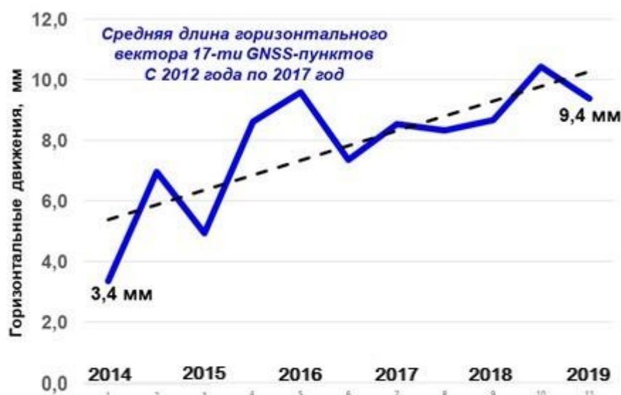
Рисунок 5.3 – Графики изменения средних значений длин векторов горизонтальной компоненты движений 17-ти GNSS-пунктов за период 2014-2019 г.г. на территории месторождения Кумколь
