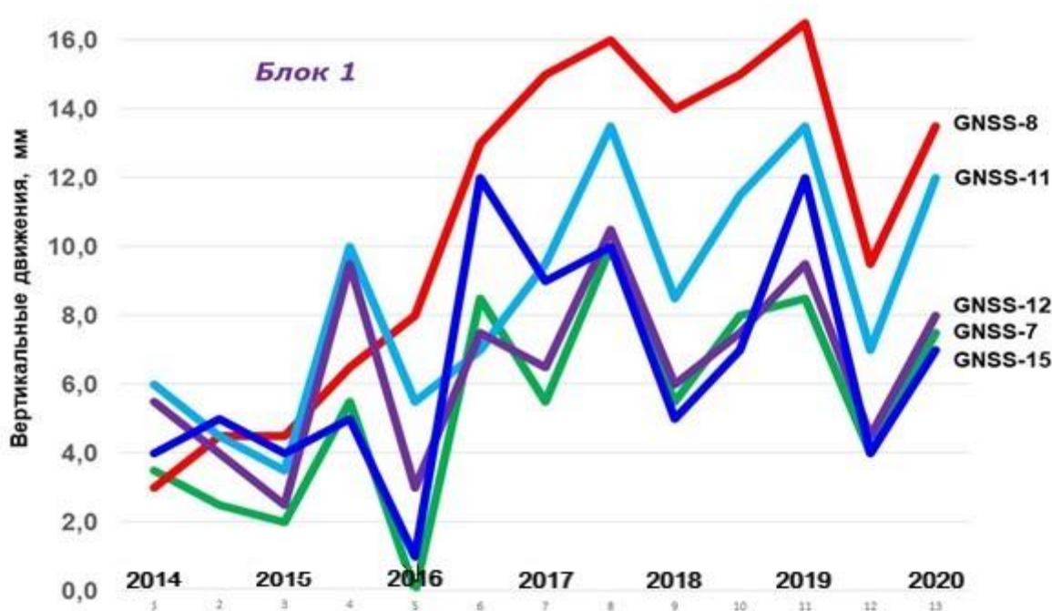
Рисунок 5.4 – Графики изменения вертикальных движений информативных GNSS-пунктов, входящих в блок 1 за период 2014-2020г.г
