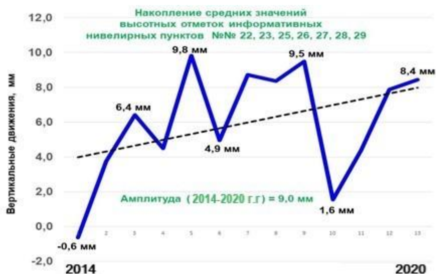
Рисунок 4.9 – График изменения (накопления) средних отметок для информативных нивелирных пунктов по мере увеличения интервала времени между циклом 1 (2014) и последующими циклами вдоль профиля 1-1
