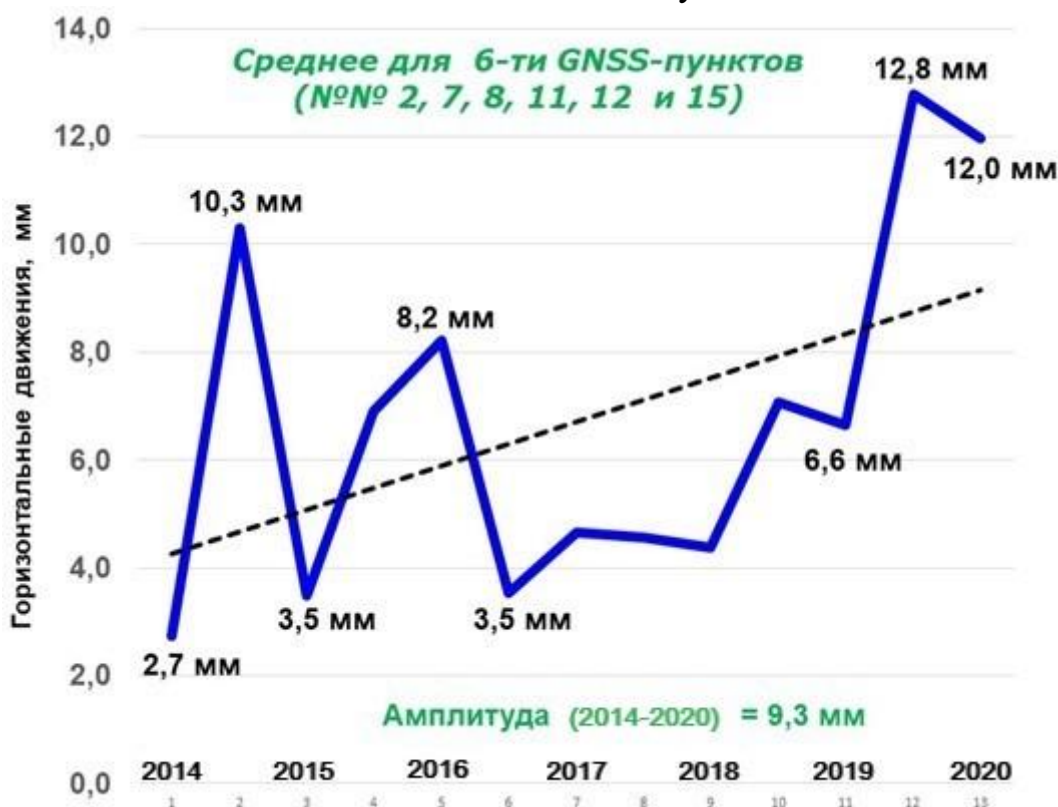
Рисунок 5.9 – График изменения средних значений горизонтальных векторов GNSS-пунктов, входящих в состав блока 1 за период 2014-2019 г.г
