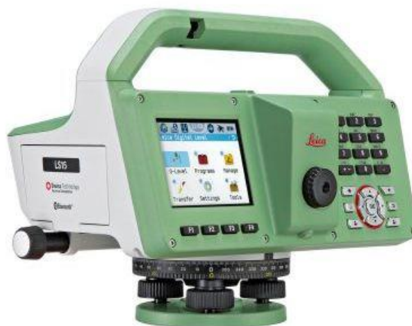
Рисунок 4.1 – Внешний вид: цифрового нивелира Leica LS15
